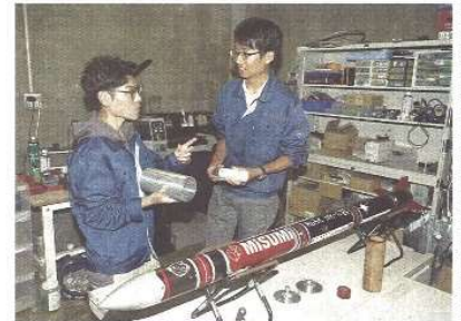
④ラスクの部室手前にあるロケットと同程度のサイズの機体打ち上げ用エンジンを開発中。実験前に燃焼室を調整する学生、ドーナツ状の部分から炎が出る仕組み
